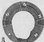
Рис. 49. Зажимное кольцо цилиндра защиты шара с винтами для крепления шаровой установки в гнезде броневой защиты танка
